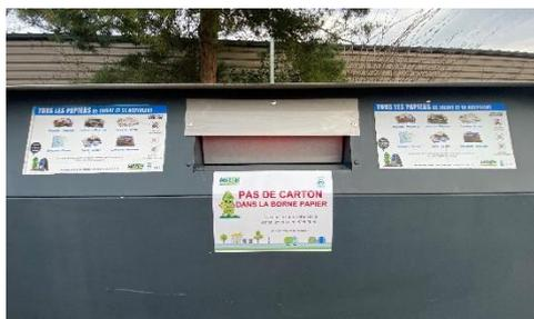
La situation est préoccupante car sans amélioration, l'unique usine de recyclage nationale menace de refuser le papier issu de notre territoire. Pour pallier à cette situation, le SMITOM doit donc agir. Des plaques de réduction sont en cours d'installation sur la trappe d'ouverture des bornes à papier. Elles doivent permettre de limiter le mauvais usage de ces points d'apport volontaire.
